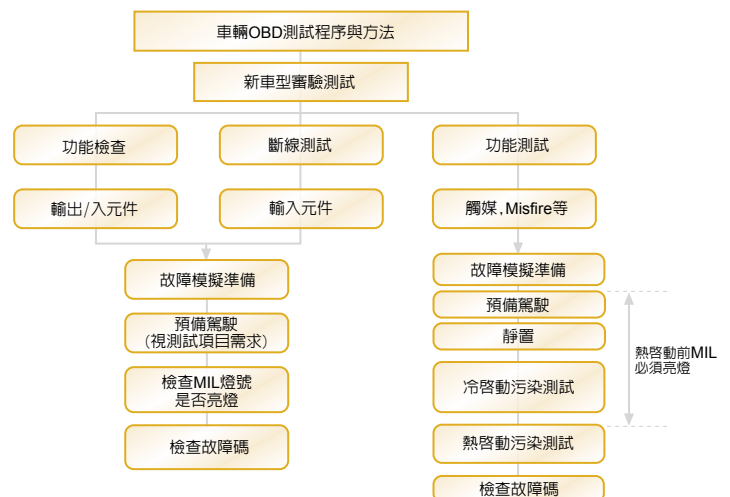
圖3 OBD認證測試流程圖(美規FTP-75測試)
